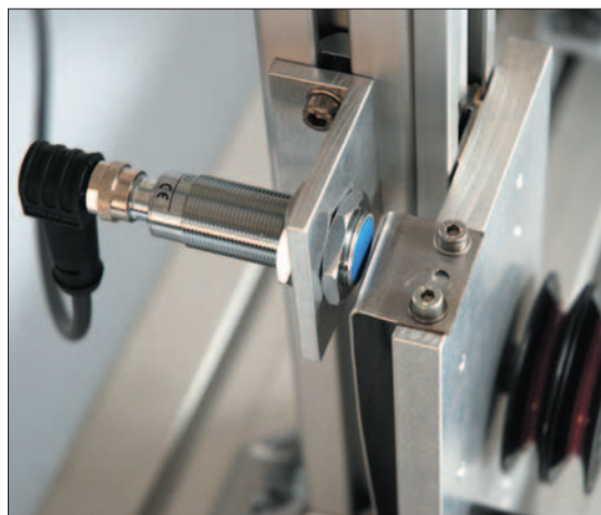
Analoge Sensor für die Anpassung der Spulendrehzahl / Analogue sensor for spool speed adjustment
